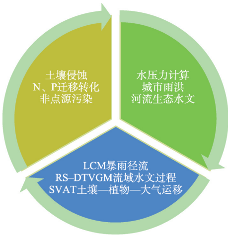
图3 EcoHAT 遥感水文模型结构 Fig. 3 Construction of the EcoHAT model
